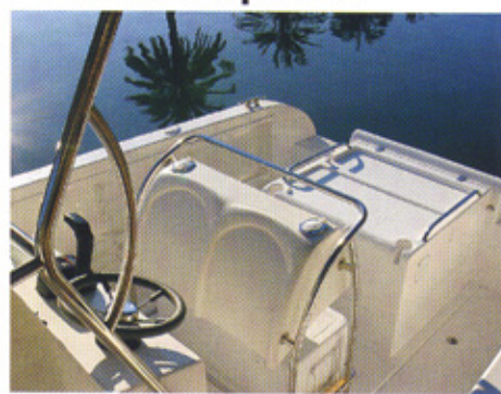
El asiento de gobierno es más un apoyo. Debajo cabe una gran nevera o un soporte de botellas de buceo.
